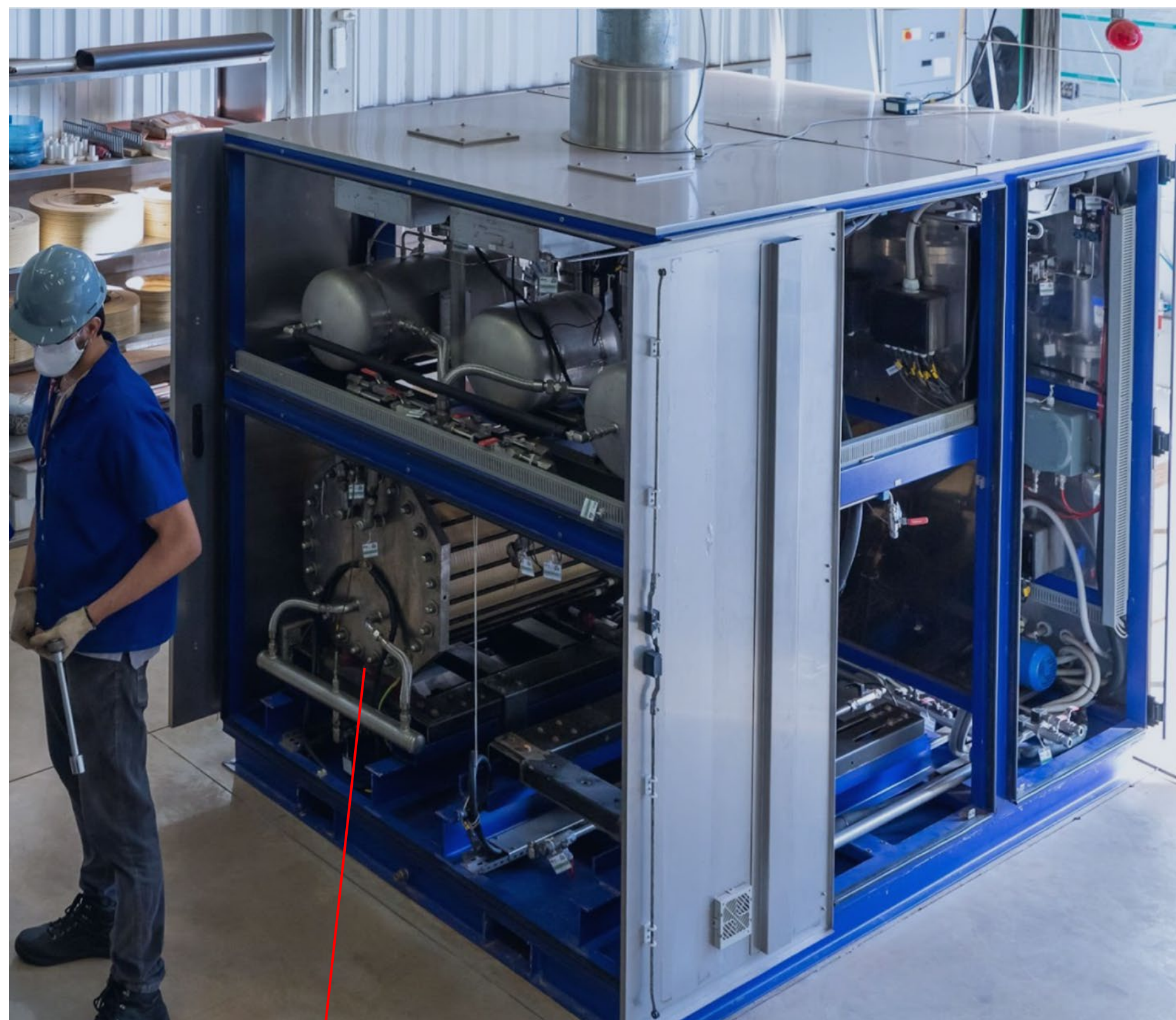
> Planta Alcalina - 60 kW 10Nm 3 /h - PTI
